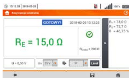
Měření odporu uzemnění
