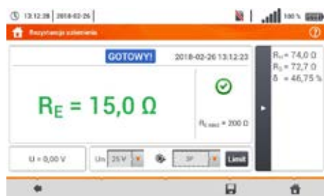
Měření odporu uzemnění
